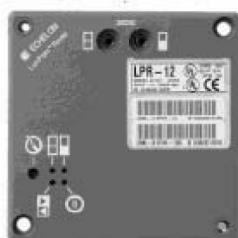
론워스 기반 라우터 모듈은 빌딩이나 산업계에 사용하기 위한 론 네트워크에서 론워스 디바이스(제어기)나 다른 론마크 인증품과 같이 신규 또는 기존의 센서나 액츄에이터와 함께 경제적이며 상호 호환성이 있는 제어시스템을 구축하기 위하여 고안된 제품으로서, 기존의 제어네트워크가 메이커 고유의 전용 게이트웨이를 폐쇄 제어회로에 링크하기 위해 사용하는 것에 비하여 론워스 디바이스(제어기)는 어떠한 디바이스든 임의의 제어 과정을 수행하면서 네트워크 상의 어떠한 위치에서도 접근이 가능하도록 개방형 분산시스템 구조를 제공한다.
