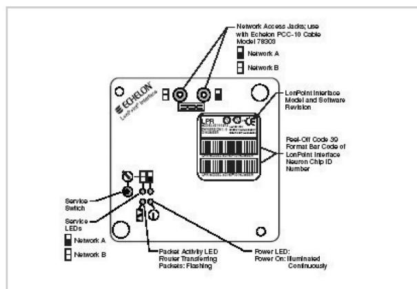
극성에 민감하지 않은 전원과 네트워크 접속방식은 오결선의 혼선을 최소화 시킨다. 두개의 전면 패널잭은 두쌍의 네트워크를 해체하지 않고 바로 접속할 수 있기 때문에 네트워크를 현장에서 조정하거나 유지 보수시에 반드시 시간을 절약해준다. 모델명, 수 정번호가 포함된 전면 패널 바코드와 2개의 제거할 수 있는 뉴런 칩 ID 스티커가 제공된다.
